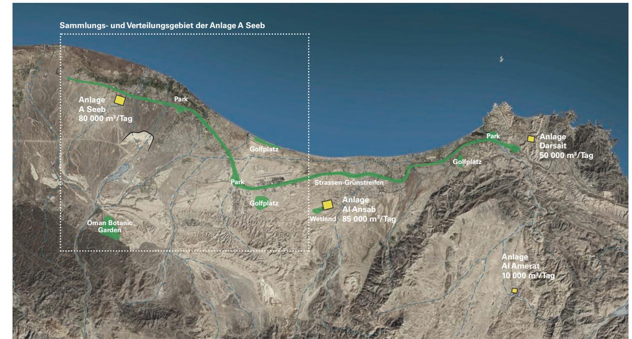
Das Abwasser-Management-System von Maskat beinhaltet vier Anlagen. Das Wasser wird mittels Biomembranreaktoren 5-fach gereinigt und weist ein Qualitätsstandard nahe dem Trinkwasser auf. 2013 wurde das A Seeb Abwasser-Projekt mit der Inbetriebnahme der Anlage A Seeb fertiggestellt. Es beinhaltet eine Hauptanlage, drei Pumpstationen, 1452 km Gravitations-Leitungen und 212 km Vakuum-Leitungen (im Küstenbereich)
