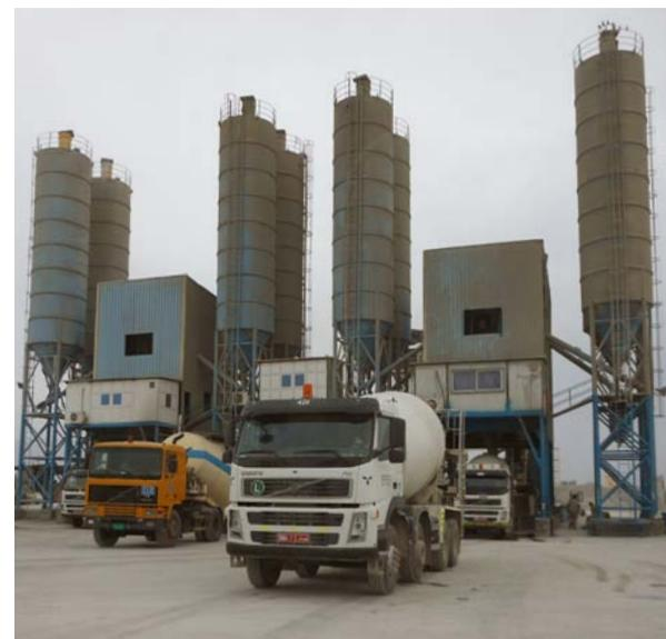
**Beladung der Lastwagen im Betonmischwerk**
