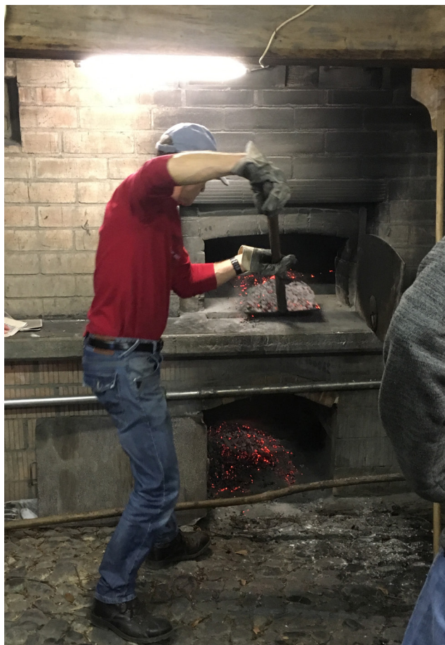
06:30 : Die Glut wird in den Aschenbehälter unterhalb des Ofens geworfen. Der Ofen wird anschliessend mit dem "Ofewüsch" gereinigt und so lange abgekühlt bis die gewünschte Temperatur erreicht ist.
