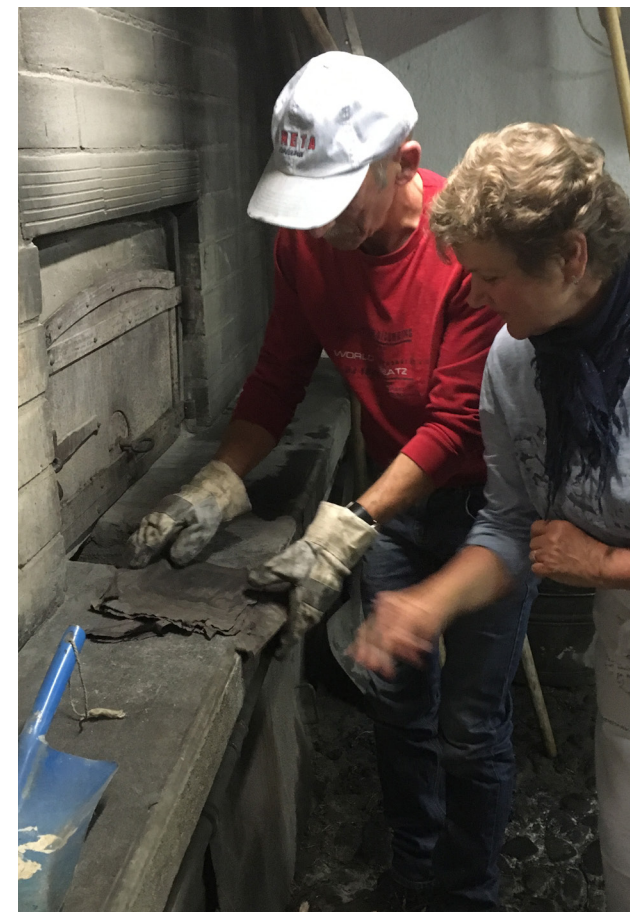
06:45 : Die Zeitungsprobe: Bleibt eine Zeitung während zwei Minuten im Ofen und kann man anschliessend den Text noch lesen, hat der Ofen die richtige Temperatur.
